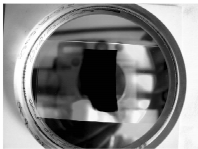
图 7 复制闪耀光栅使用后损伤情况照片
